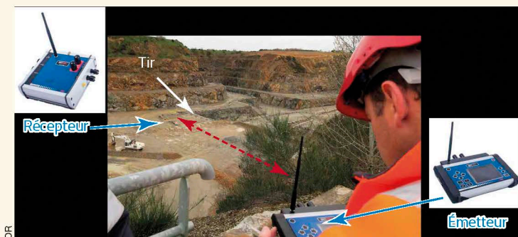
Mise à feu à distance par radio avec le système Daveytronic.
