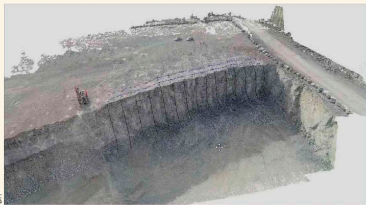
Nuage de points en 3D et profils critiques sur la première rangée de forage.
