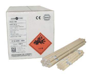
La CISALITE est un système continu sous la forme d'un chapelet de cartouches d'émulsion faible énergie en diamètre supérieur à ceux du CISALEX. Un cordeau détonant fixé en deux points sur chaque cartouche assure la continuité de l'amorçage tout au long du chapelet. La CISALITE est plus particulièrement destinée au pré-découpage ou post-découpage des talus en terrassement rocheux.
