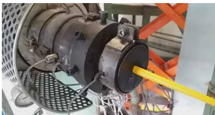
Sur la photo : Gainage à chaud d'un cordeau 20 g
