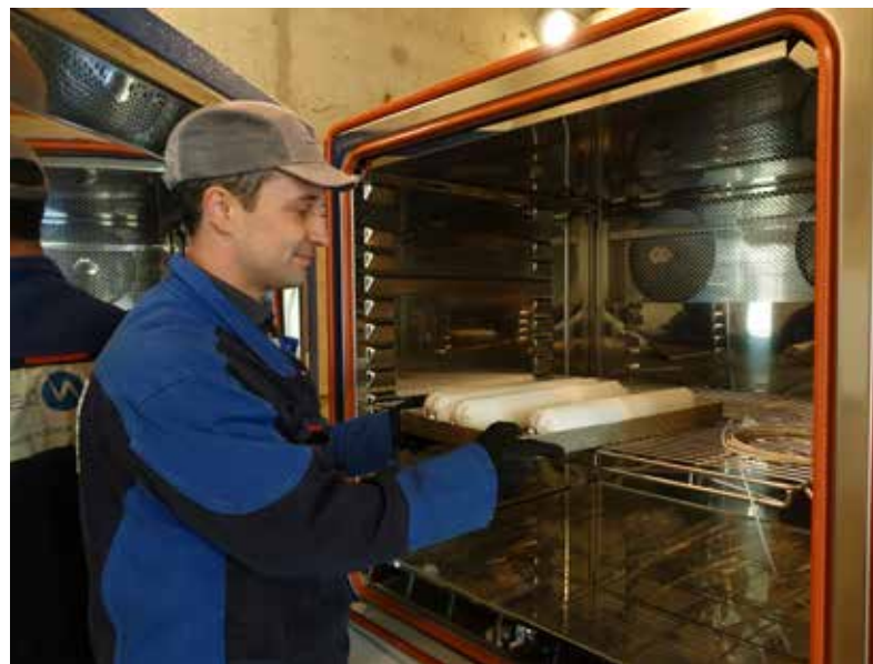
Contrôle performance : test de vieillissement artificiel en cours dans une enceinte de cyclage
