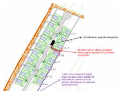
Exemple d'outil Lean : Le diagramme spaghetti représente les déplacements des opérateurs lors du chargement d'un conteneur à Champs-Passy. Il permet de visualiser si il y a des gaspillages de déplacements, ici il n'y en avait pas !
